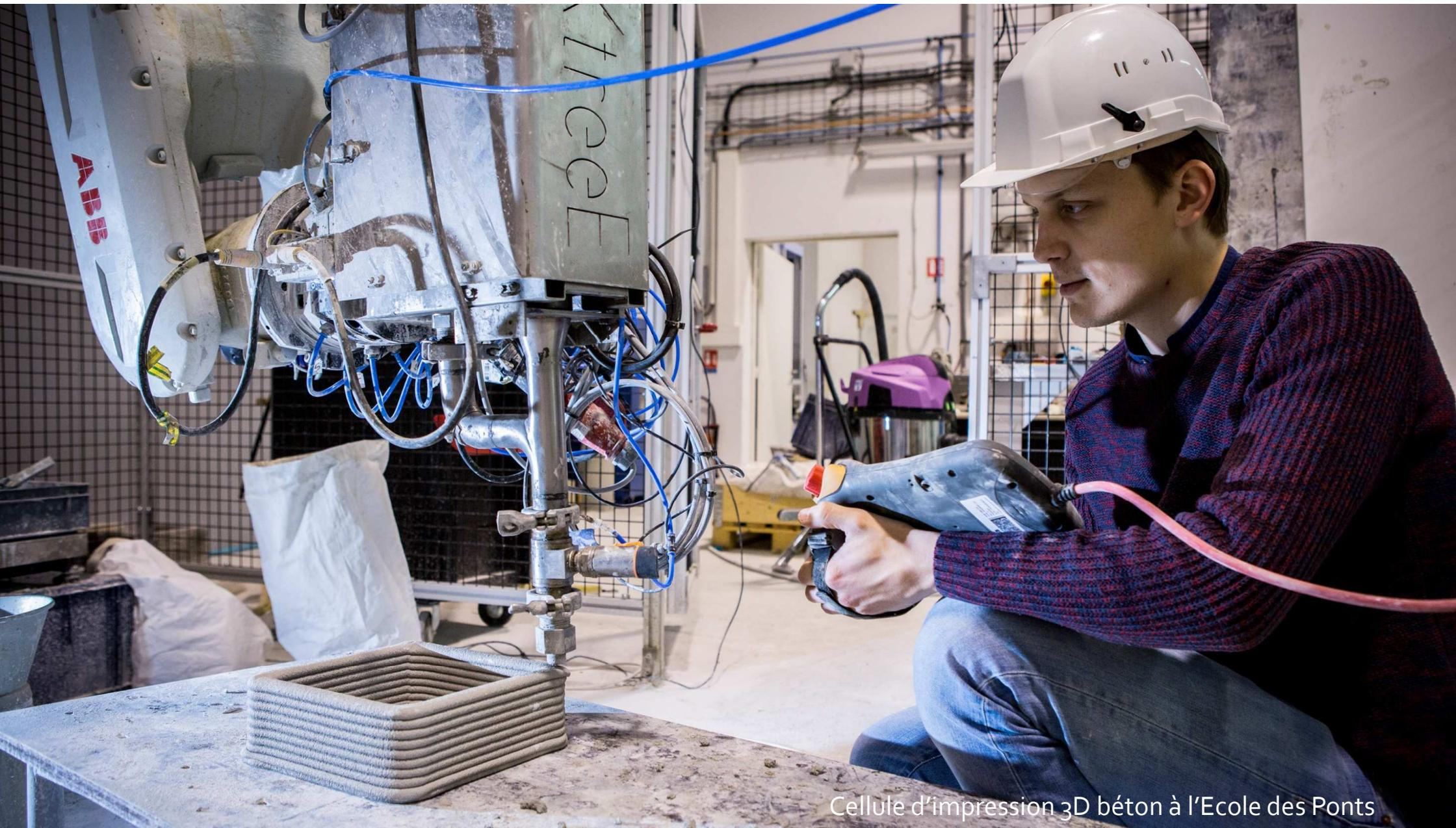
Cellule d'impression 3D béton à l'Ecole des Ponts
